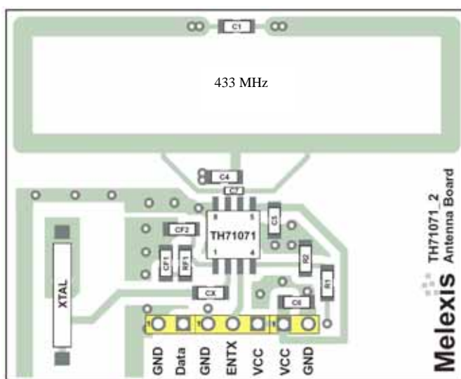
图 1.6.4 TH71071 采用 PCB 天线的应用电路
