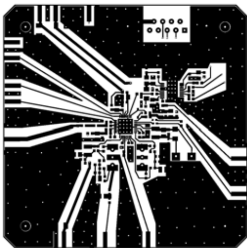
(a) 印制板图 (元器件面)
