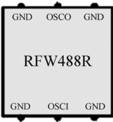
图 3.10.3 RFW488R-A 谐振器芯片的引脚封装形式
