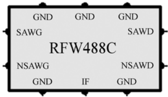
图 3.10.2 RFW488C-A 相关器芯片的引脚封装形式
