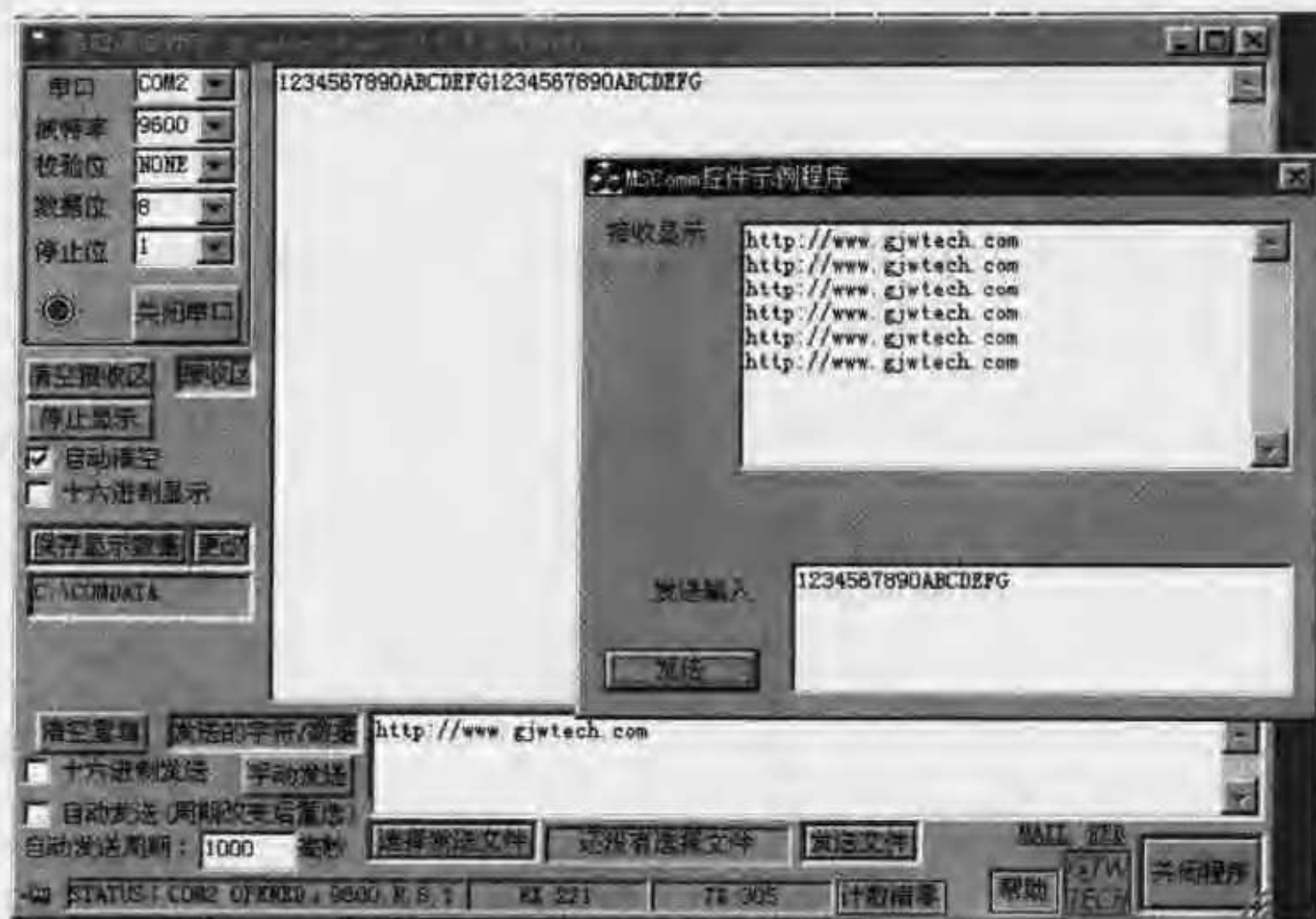
图 1.2.9 利用串口调试助手测试串口接收与发送功能
