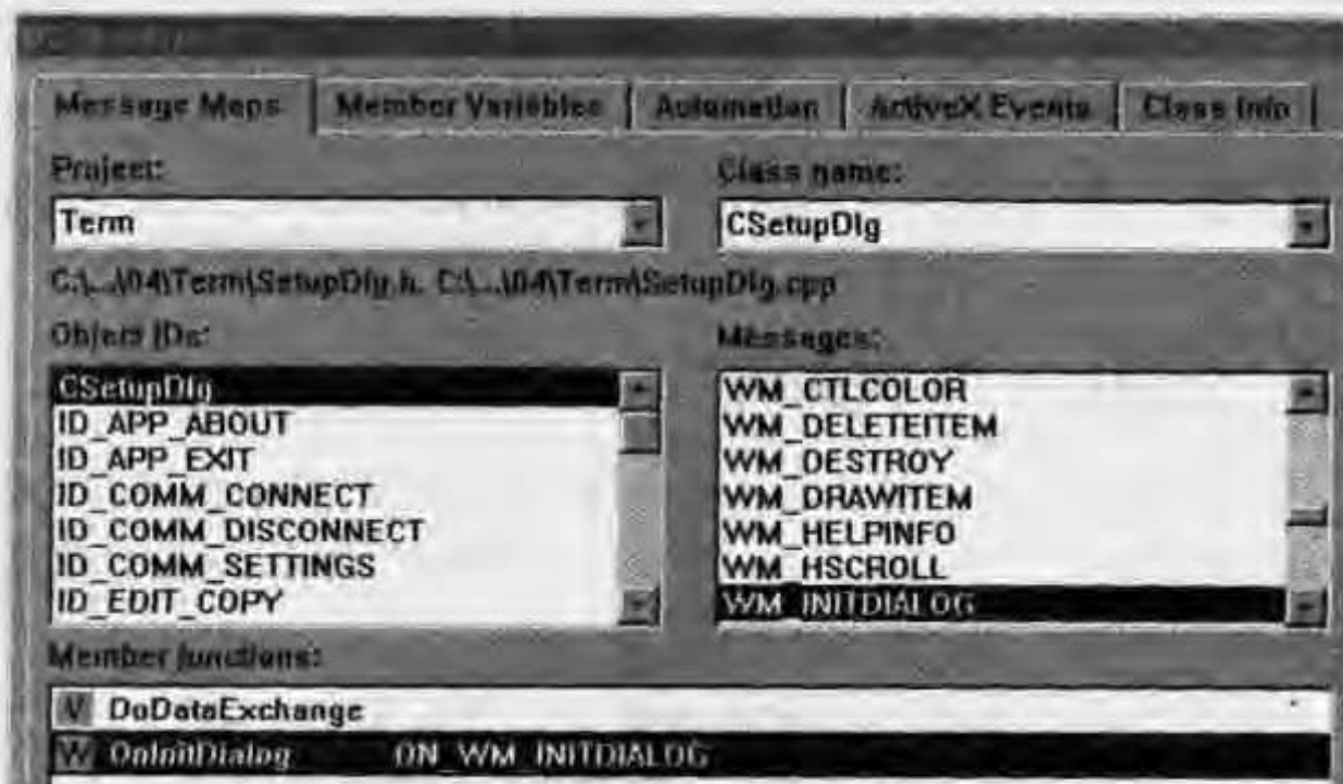
图 4.6.6 在 CSetupDlg 类中添加 OnInitDialog 成员函数
