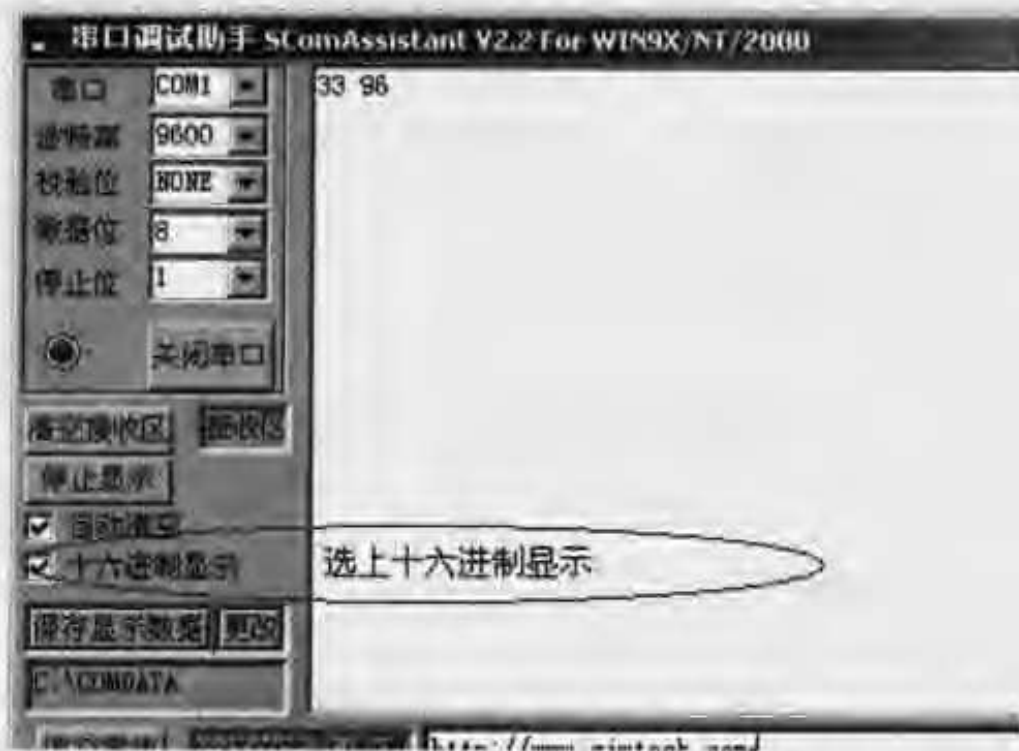
图 2.4.1 测试 NNTest 发送含 NULL 的字符串数据
