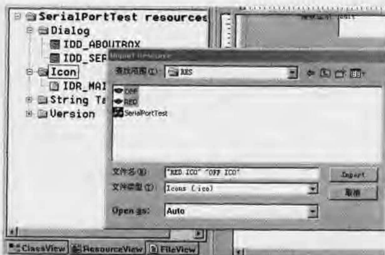
图 7.2.2 导入 RED 和 OFF 两个图标
