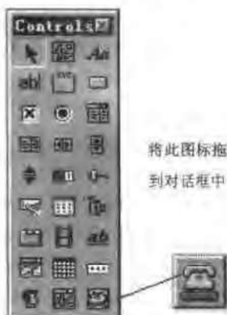
图 3.2.1 插入 MSComm 控件后出现在对话框控件工具栏上的图标
