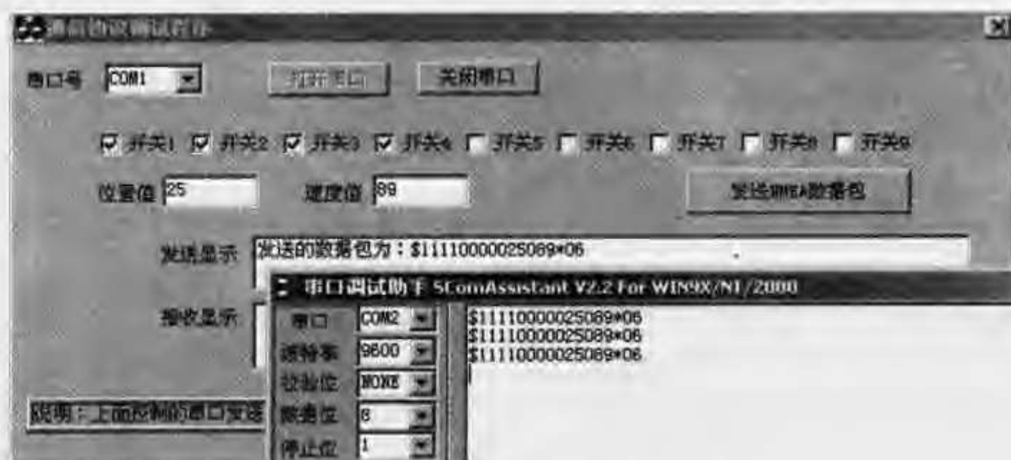
图 7.2.5 利用串口调试助手测试程序
