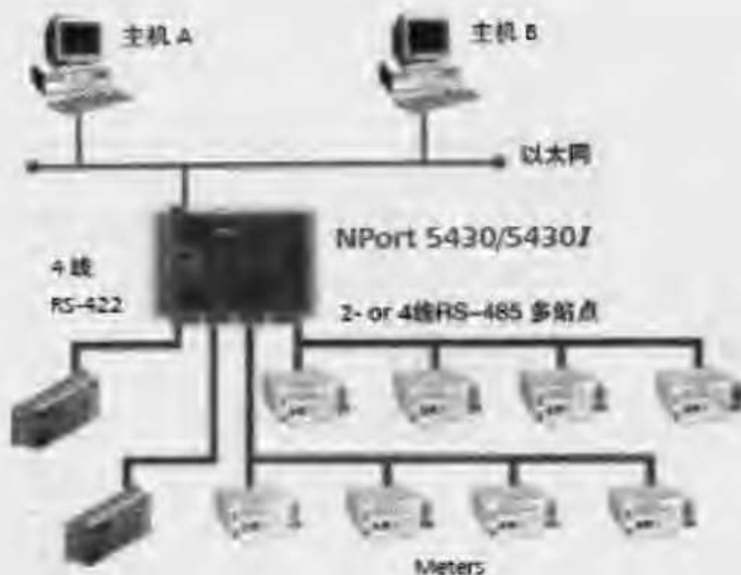
图 9.2.5 典型应用 3：集中的 RS-422/485 串口设备控制
