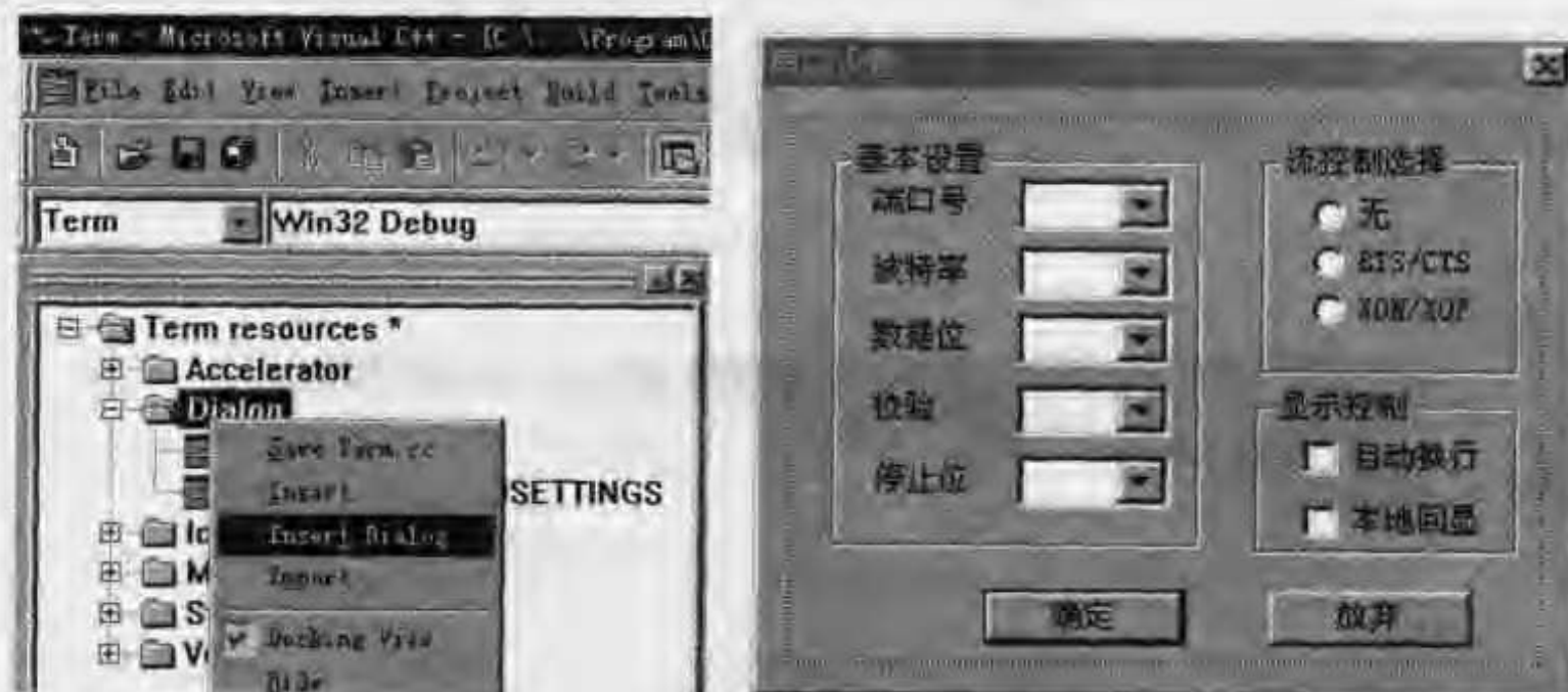
图 4.6.2 添加串口设置对话框
